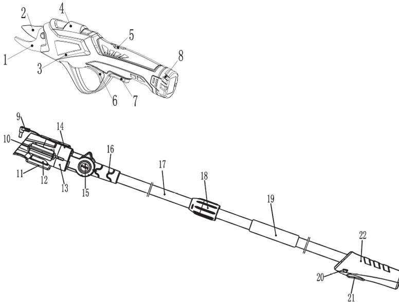
1. Feststehende Klinge 2. Klinge 3. Antriebskopf 4. Design Blenden 5. Steckeranschluss 6. Abzug 7. Abzug-Sicherung 8. Akku 9. Verbindungsstecker 10. Spange I 11. Spange II 12. Verschluss 13. Halterung I 14. Halterung II 15. Schenkknopf 16. Stangenverbindung 17. Verbindungsrohr 18. Verbindungsstück 19. Handgriff 20. Abzugssperre 21. Abzug 22. Griff
