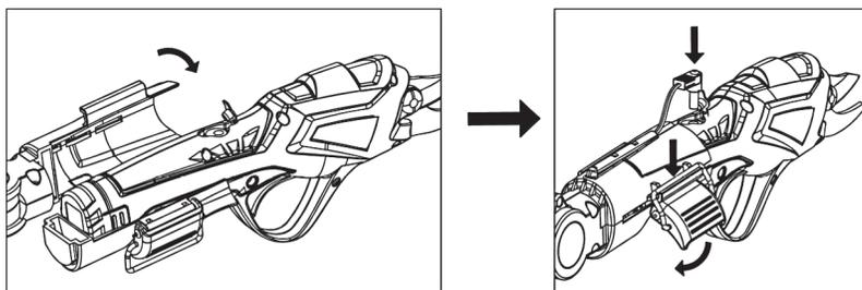
Erst nachdem die Schere durch den Stecker gesichert ist, Klammern der Halterung schließen
