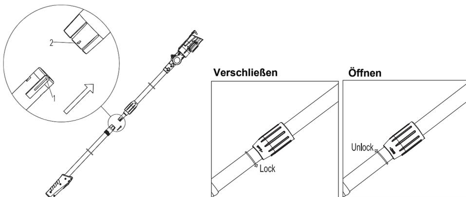
**Die Akkuschere in die Astverlängerung einsetzen**
