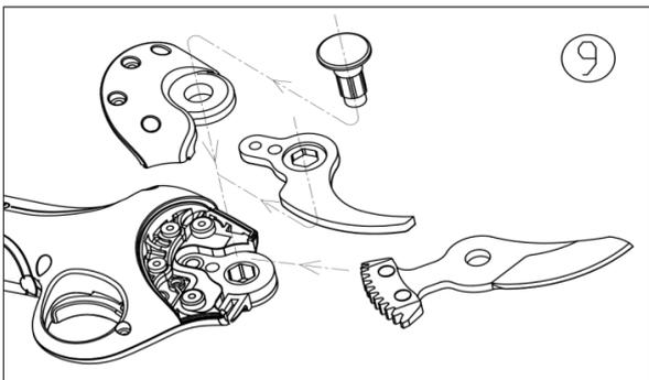
9. Messersatz montieren, Deckel aufsetzen und Zentrierbolzen einsetzen.
