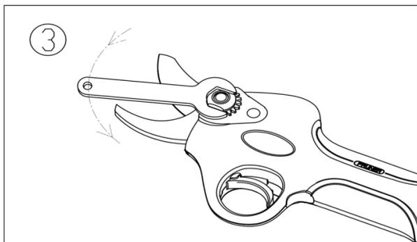
3. Lösen Sie die Überwurfmutter mit einem Schraubenschlüssel.
