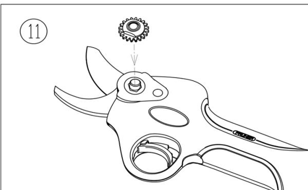
11. Setzen Sie die Überwurfmutter auf die Mittelschraube.
