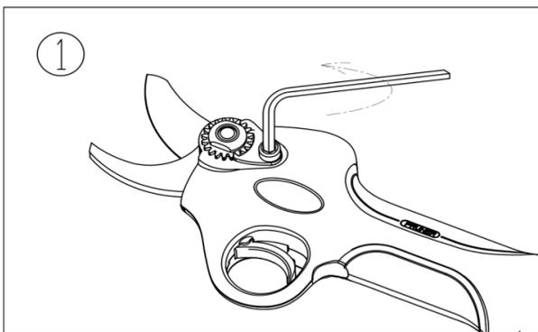
1. Lösen Sie die Einstellschraube mit einem Inbusschlüssel.
