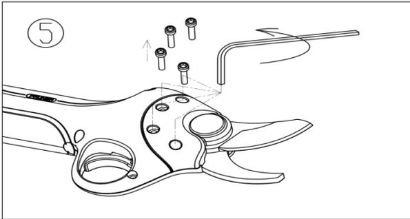
5. 4 Deckelschrauben mit Inbusschlüssel lösen.
