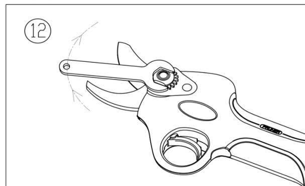
12. Ziehen Sie die Überwurfmutter mit einem Schraubenschlüssel an.
