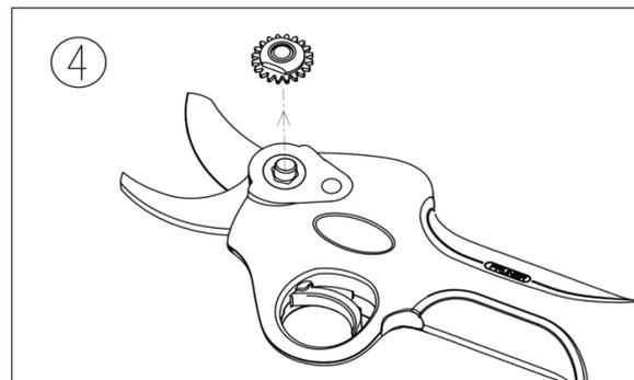
4. Einstellgetriebemutter entfernen.
